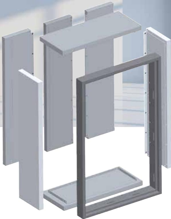
Tresore in zerlegbarer Ausführung werden in den Widerstandsgraden IV(KB) und V(KB) angeboten. Sie kommen bei schwierigen Transport- und Einbringungssituationen zum Einsatz. Die Schränke werden in Elementen gefertigt und geliefert. Der Zusammenbau erfolgt bauseits am Aufstellort durch Verschrauben.
